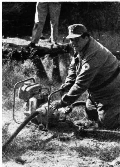
Der Saugkopf wird in das Schmutzwasser, einen Tümpel, geworfen, eine Motorspritze führt das Wasser dem Aufbereitungsgerät im VW-Bus zu.
