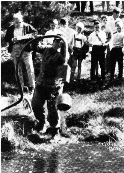
Der Saugkopf wird in das Schmutzwasser, einen Tümpel, geworfen, eine Motorspritze führt das Wasser dem Aufbereitungsgerät im VW-Bus zu.
