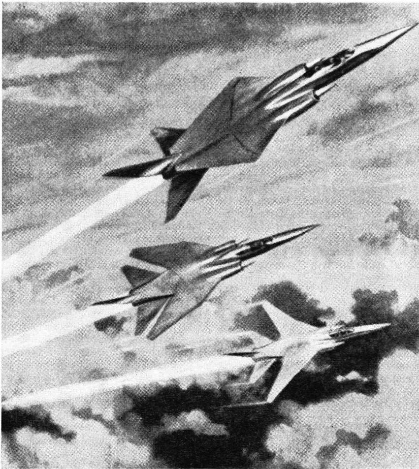
Eine Skizze der «variablen Geometrie» des F-111. In dieser Zeichnung sind die zwei extremen Stellungen der Flügel und eine Mittelstellung abgebildet.
