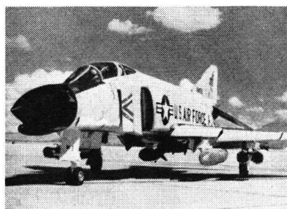
Phantom-2 der amerikanischen Luftwaffe. Man beachte die vier Raketenbehälter unter den Flügeln und die Bomben unter dem Rumpf. Gut sichtbar ist unter der Radarnase das verkleidete Infrarotgerät.
