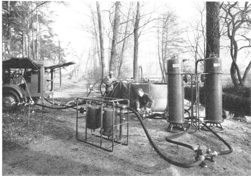
Terratom-ABC-Dekontaminierungsanlage in Betrieb. Man sieht in der Mitte hinten die faltbaren Becken der Vorbehandlung (mit Erde und Zusatzmitteln), links die B-Entkeimung mit elektrolytischer Chlorgas-Erzeugung, rechts den Ionenaustauscher (ohne Kunstharz, im Na-Zyklus), vorn Mitte die Nachbehandlungsgruppe zur Konditionierung.
