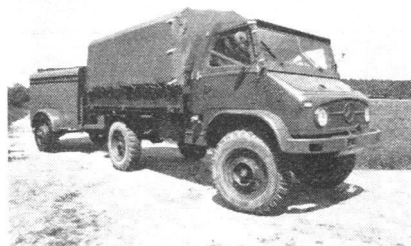
Terratomanlage auf dem Marsch. Auch diese Anlage kann mit Hubschraubern transportiert werden. Dabei wird das im Lastwagen befindliche Gerät im Lastennetz geflogen, in einem zweiten Flug der komplette B-Anhänger.
