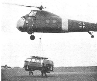
Auch das Schnelleinsatzgerät ist dank einem Speziesschweissgeschirr durch Hubschrauber verlastbar. Gesamtgewicht über 1500 kg.
