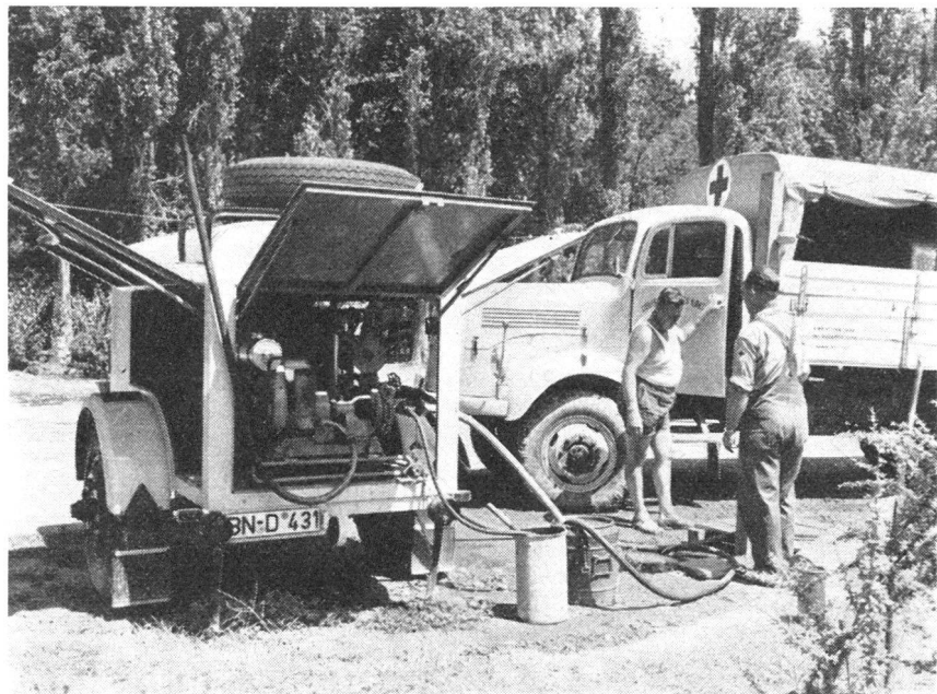
Fahrbarer Anschwemmfilter mit Entkeimung des Deutschen Roten Kreuzes im Stadtpark von Skoplje. In dem Park lagerten zeitweise bis zu 10 000 Menschen.
