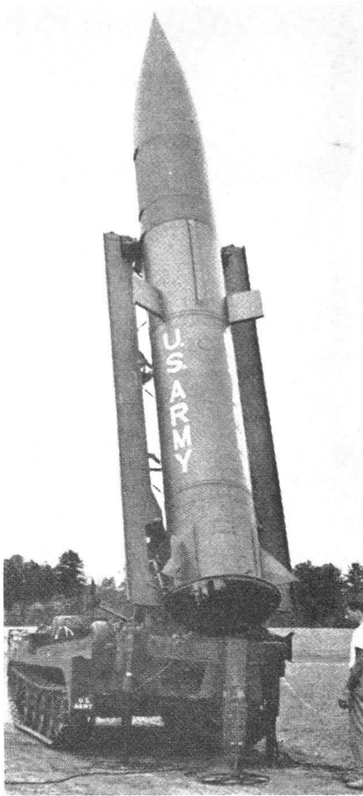
«Pershing»-Lenkwaffe wird zum Abschuss bereitgestellt. Man beachte das Träger-Raupenfahrzeug XM-474 und die darauf abgestützte TEL-Einrichtung für das Aufrichten und Starten des Flugkörpers.
