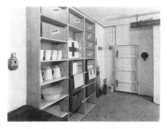
«Küche» mit Essgeschirrkisten und einem Teil des Notvorrates. Rechts oben ein Zuluftrohr, darunter das der Abluft dienende Ueberdruckventil.
