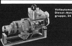
Vollautomatische Diesel-Notstrom-gruppe, 24 kW
