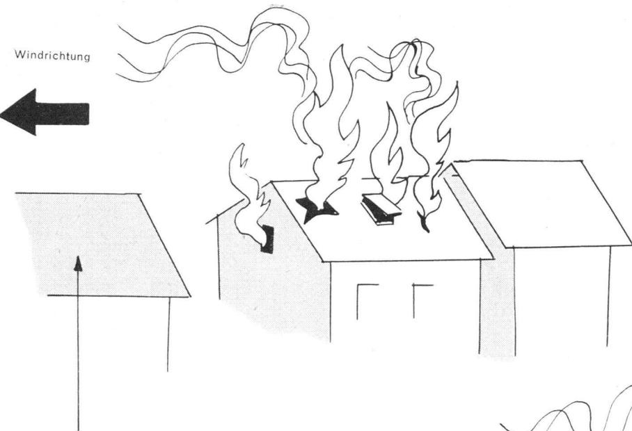
Das Feuer durchbricht die Dachhaut. Dieser Durchbruch kann sich je nach der Dachbedeckung längere Zeit hinziehen. Flammen schlagen aus den im Dach entstandenen Öffnungen. Diese erweitern sich, bis der ganze Dachstuhl in Flammen steht. Hitze und Flammen gefährden die benachbarten Gebäude (spez. deren Dächer!).
