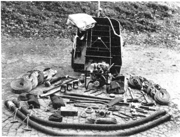
Die Geräteausstattung der Kraftspritzenstaffel
