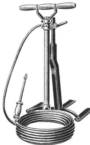
Massive, korrosionsbeständige Messingkonstruktion – daher absolut widerstandsfähig. Leichter Gang, zuverlässige Stopfbüchsen System Birchmeier!
