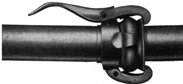
aus Bandstahl, überlappt, geschweisst, absolut dicht, stark abwinkelbar, feuerverzinkt. Durchmesser: 50, 62, 70, 89, 108, 133, 159 mm. Sämtliche Armaturen.
