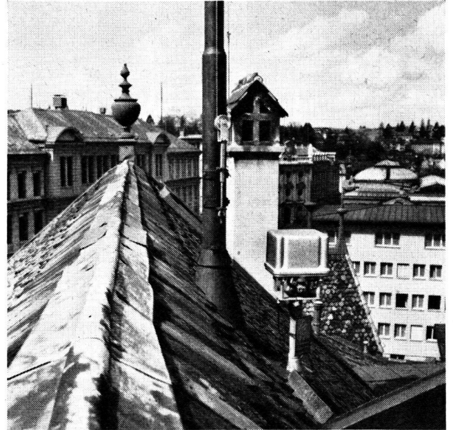
Das Ueberwachungsgerät EXA 2, hier versteckt über den Dächern der Bundesstadt montiert, ist mit einer Ionisationskammer mit Abtastung und Impulsverstärker versehen und verfügt auch über einen Mechanismus für Kontrollbestrahlung.
