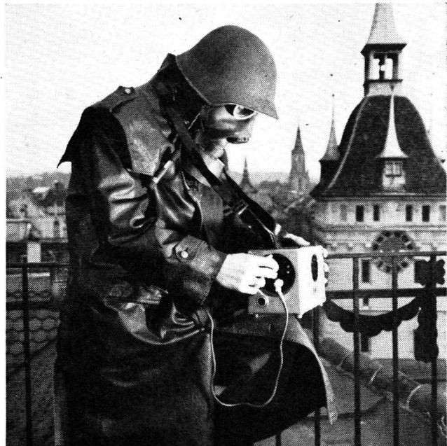
Dem Alarm durch das Ueberwachungsgerät folgt die Messung der Stärke der Radioaktivität mit dem Messgerät. Ein Vorgang, der alle 30 Minuten wiederholt und gemeldet werden muss.
