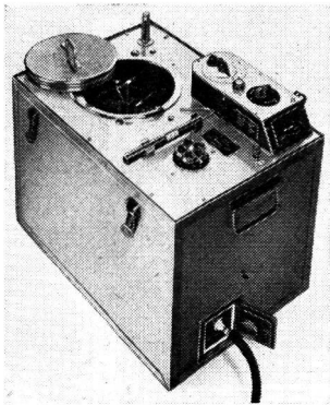
Der Densomat, das automatische Film- entwicklungsgerät.
