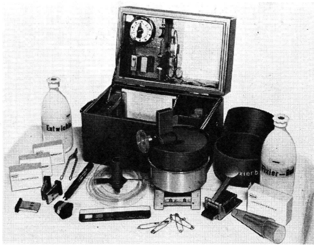
IDOS-Tageslichtbox, welche die Entwicklung von 100 bis 200 Filmbältern pro Stunde zulässt und sich z. B. für Einheiten, kleine Gemeinden oder Betriebe der Landwirtschaft eignet.
