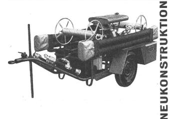
Gedrängt und doch gut zugänglich gebaut. Mit abprotzbarem Tragschlitten. Weitgehende Verwendung von Leichtmetall und damit geringeres Gesamtgewicht. Vakuum-Erzeugung mittels bewährtem Brun-Gasstrahler.
