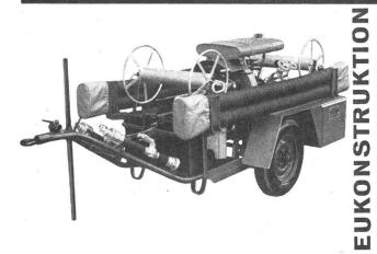
Gedrängt und doch gut zugänglich gebaut. Mit abprotzbarem Tragschlitten. Weitgehende Verwendung von Leichtmetall und damit geringeres Gesamtgewicht. Vakuum-Erzeugung mittels bewährtem Brun-Gasstrahler.
