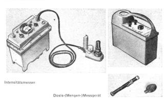
Es kann Dir ein Dosismessgerät zugeteilt werden — ein Initialdosis-Messer — der es den Sanitätern ermöglicht, mit Hilfe eines besonderen Ablesegerätes rasch festzustellen, welche Strahlungsmenge Du allenfalls durch die Initialstrahlung bekommen hast, und die Behandlung danach zu richten. Um darüber zu wachen, dass die Strahlungsdosis später nicht zu gross werde, wenn Du Dich in radioaktivem Gelände aufhalten musst, kannst Du dann ein Mengen-Messgerät anderer Art zugeteilt erhalten.
