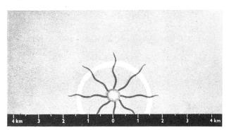
Nach einer Sekunde hat der Feuerball einen Durchmesser von etwa 300 m. Eine Luftdruckwelle breitet sich
