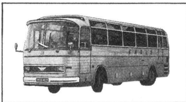
1) Continental Trailways: Bus und Autocar Motor: GM-Diesel 6 V-53 (182 PS) Getriebe: Allison MT-41 (Automat)
