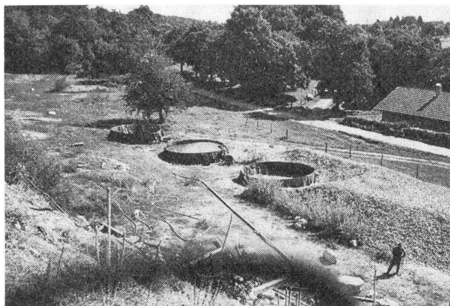
Mobile Löschwasserbecken lieferten das Wasser für die vielseitigen Versuche
