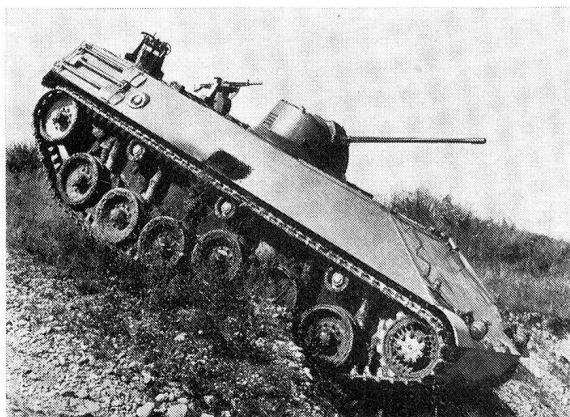
gepanzertes Transportfahrzeug handelt, welches mit einer Bordwaffe ausgerüstet ist, dessen Bedienung über keinen Panzerschutz verfügt. Die Mannschaft kann den aufgesessenen Kampf nur dann und beschränkt führen, wenn sie die Waffen über Bord, also ungeschützt, einsetzt. Durch die hohen Verluste der Amerikaner mit dem M 113 in Vietnam, welche
