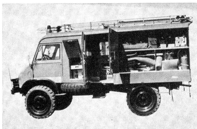
fahrzeug auf ein Unimog-S-Chassis aufgebaut, das dank dem Allradantrieb und der Differentialsperre in Vorder- und Hinterachse eine hervorragende Geländegängigkeit aufweist. Der Unimog-S ist mit
