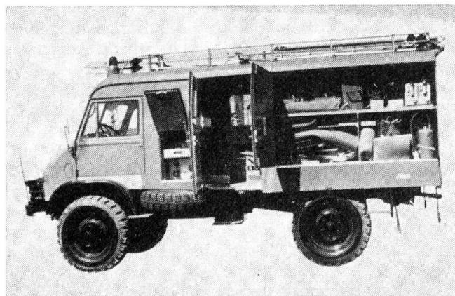
fahrzeug auf ein Unimog-S-Chassis aufgebaut, das dank dem Allradantrieb und der Differentialsperre in Vorder- und Hinterachse eine hervorragende Geländegängigkeit aufweist. Der Unimog-S ist mit
