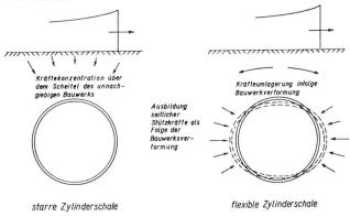
Abb. 5. Unterschiedliche Beanspruchung starrer und flexibler Zylinderschalen
