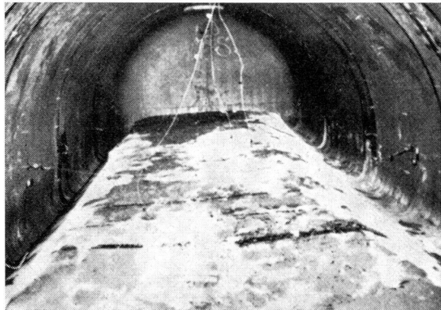
Abb. 1. Nach innen gebogene, ursprünglich korbbo-genförmige Sohle eines Versuchsbauwerkes mit Blechfutter unter Betonmantel als Folge der seitlichen Ansprengung ( R = 6 m) im Grundwasser. Trotz der grossen Verformung um etwa \frac{1}{3} des ursprünglichen Durchmessers und bei einem Grundwasserspiegel bis nahe an den Scheitel bleibt der Körper vollkommen dicht.
