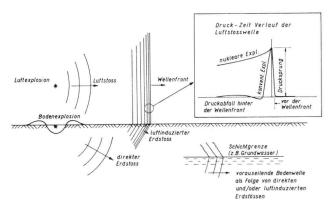
Abb. 1. Ausbreitung von Luft- und Erdstosswellen
