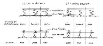
Abb. 4. Modell zur Darstellung von Kräfteumlagerungen im Boden
