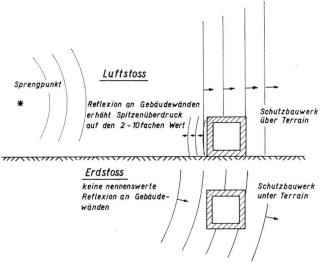
Abb. 2. Beanspruchung über- und unterirdischer Bauwerke durch Stosswellen
