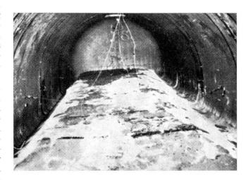
Abb. 1. Nach innen gebogene, ursprünglich korbbogenförmige Sohle eines Versuchsbauwerkes mit Blechfutter unter Betonmantel als Folge der seitlichen Ansprengung ( $R=6\,\mathrm{m}$ ) im Grundwasser. Trotz der grossen Verformung um etwa  $^{1/3}$  des ursprünglichen Durchmessers und bei einem Grundwasserspiegel bis nahe an den Scheitel bleibt der Körper vollkommen dicht.
