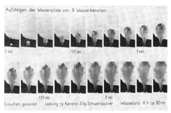
Abb. 5. Fortschreitende Entwicklung des Wasserpilzes bei einem Versuch mit 9 Wasserkanonen.
