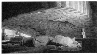
Abb. 15. Absprengungen auf der Unterseite eines Kalksandsteingewölbes infolge einer Einzellast auf dem Scheitel
