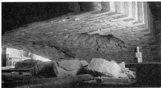
Abb. 15. Absprengungen auf der Unterseite eines Kalksandsteingewölbes infolge einer Einzellast auf dem Scheitel
