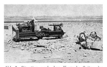
Abb. 3. Situation nach dem Versuch: Spitze des Druckstosses etwa 0,7 atü, Spitze des zugehörigen Windes etwa 420 km/h. Die «weggeblasenen» Wandtrümmer und die verschobene Drehbank sind typische Merkmale für die Wirkungen der sehr starken Luftströmungen
