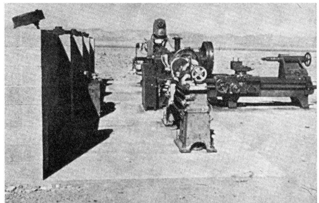
Abb. 2. Drehbänke von 3,5 bzw. 5 Tonnen hinter einer Zementsteinmauer vor dem Versuch
