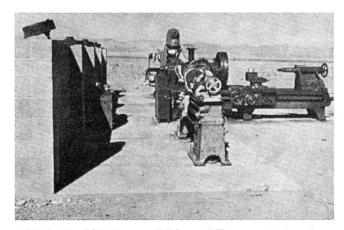
Abb. 2. Drehbänke von 3,5 bzw. 5 Tonnen hinter einer Zementsteinmauer vor dem Versuch
