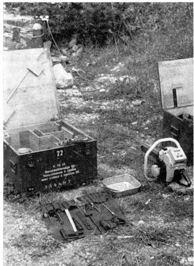
Abb. 13. Benzinkettensäge, gegen Trennschleifer auswechselbar
