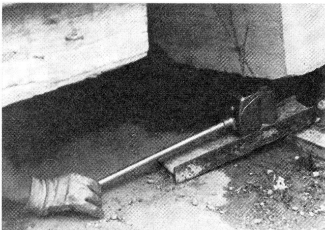
Hydraulischer Heber 5 t zur Arbeit in beengtem Raum
