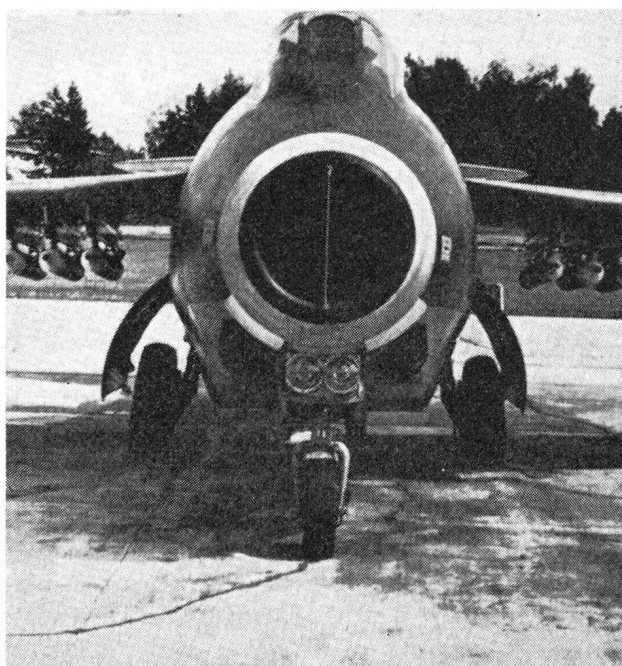
Abb. 2. Für das Einfangen von radioaktivem Staub in der Atmosphäre werden Flugzeuge vom Typ S 29 C verwendet. Unter den Tragflächen hängen sechs Filterkapseln.
