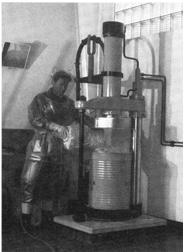
Abb. 3. Arbeiten in einem belüfteten Schutzanzug. Die Frischluftzufuhr erfolgt über eine Schlauchleitung.
