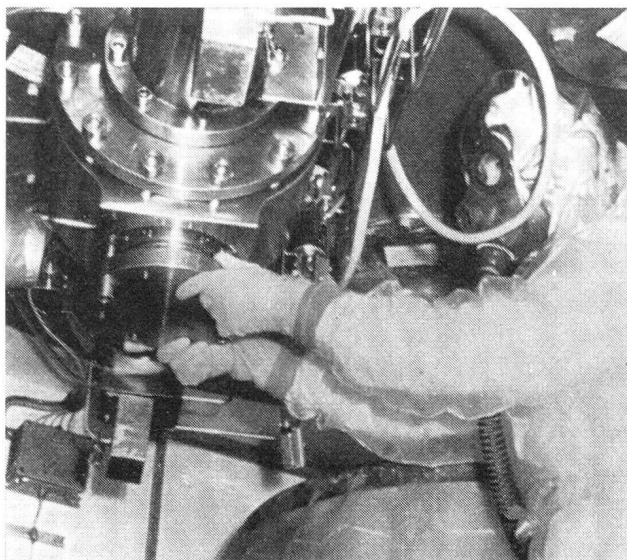
Abb. 2. Montagearbeiten in einem unbelüfteten Schutzanzug. Als Atemschutz dient eine Gasmaske.
