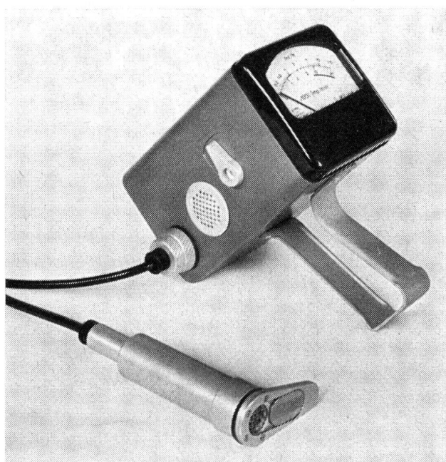
Abb. 3. Tragbares Suchgerät (transistorisiert)
