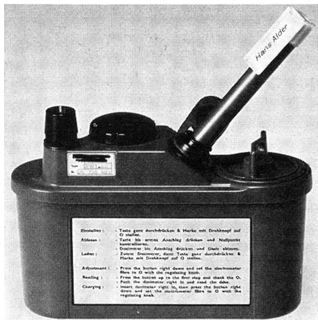
Abb. 4. Taschendosimeter mit Lade-Ablesegerät
