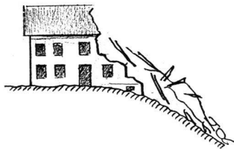
Abb. 4. Schematische Darstellung der angestrebten Trümmersituation.
