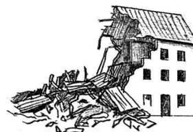
Abb. 2. Wirklichkeitsnaher Abriss vom Restgebäude, mit Hohlräumen und Schadenelementen durchsetzter Schutthang.
