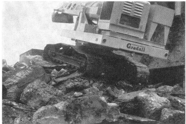
Trümmergängigkeit des Raupenfahrwerks.
