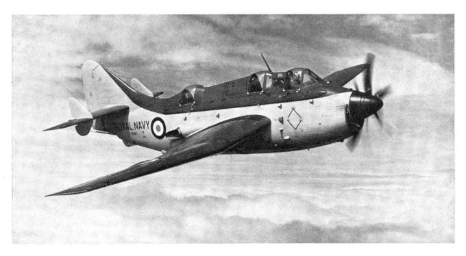
für die Seeaufklärung ein. — Bei uns dürfte diese Maschine lediglich als Zielschleppflugzeug in Frage kommen. Es handelt sich um eine überaus robuste Konstruktion mit einem Startgewicht von etwa 9700 Kilogramm. Das Triebwerk ist eine Propellerturbine «Double Mamba» von Armstrong Siddeley Ltd., die dem Flugzeug eine Maximalgeschwindigkeit von 495 km/h verleiht bei einer durchschnittlichen Geschwindigkeit von etwa 409 km/h.
