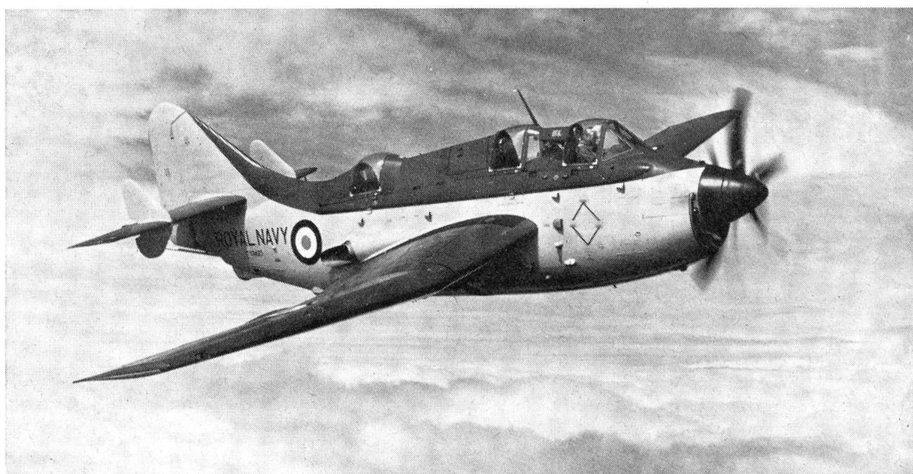
für die Seeaufklärung ein. — Bei uns dürfte diese Maschine lediglich als Zielschleppflugzeug in Frage kommen. Es handelt sich um eine überaus robuste Konstruktion mit einem Startgewicht von etwa 9700 Kilogramm. Das Triebwerk ist eine Propellerturbine «Double Mamba» von Armstrong Siddeley Ltd., die dem Flugzeug eine Maximalgeschwindigkeit von 495 km/h verleiht bei einer durchschnittlichen Geschwindigkeit von etwa 409 km/h.
