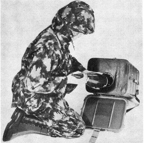
Mosquito-Schütze am Lenkgerät. Bis zu sechs Lenkwaffen können am Lenkgerät gleichzeitig angeschlossen werden. Der Schütze wählt die startende Lenkwaffe, drückt mit der linken Hand auf die Starttaste (siehe Bild oben) und lenkt die Mosquito mit der rechten Hand ins Ziel
