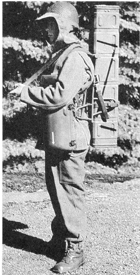
Das gesamte Bantam-System ist leicht von einem Mann zu tragen. Mit Transport- und Abschussbehälter, Erhöhungsstütze, Kabel und Kommandogeber wiegt es 19 kg. Die persönliche Ausrüstung mit Maschinenpistole beträgt etwa 7 kg.
