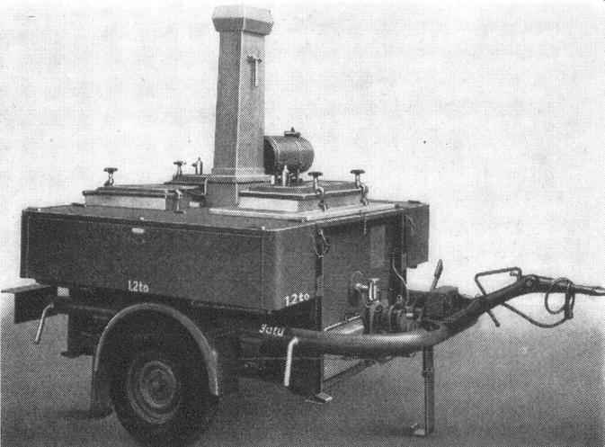
einsetzbar als Anhängerküche, stationäre Küche und auf LKW montiert, beheizbar mit flüssigen und festen Brennstoffen, ausgestattet mit zwei Kochkesseln, einem Bratentopf und einer Warmhalteröhre, für Zubereitung von ca. 250 Portionen, zwei Gerätekästen mit Wirtschaftsgerät, abgesetzt als Arbeitstische verwendbar.
