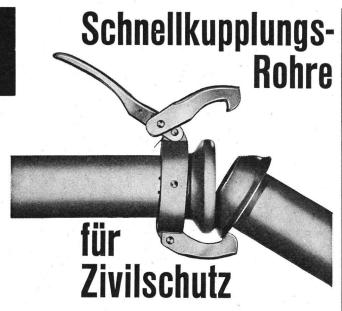
aus blankgeglühtem Kaltbandstahl mit einer Festigkeit] von ca. 40-50 kg/mm², Rohrlängen 6 m, in feuerver-] zinkter Ausführung, gemäss den eidg. Vorschriften der Abteilung für Luftschutz.
