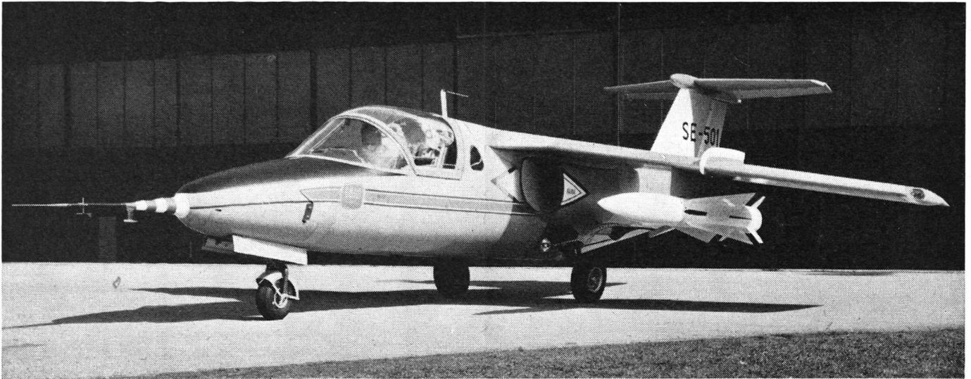
Der neue Saab-105-Jet-Trainer, den die Svenska Aeroplan AB mit einem Kostenaufwand aus eigenen Werkmitteln von 20 Mio Schwedenkronen entwickelt hat. — Einige Bau- und Leistungsdaten dieses schnittigen Flugzeuges von vielseitiger Verwendungsart: Flügelspannweite: 9,5 m, Länge 10,5 m, Leergewicht 2325 kg, Spitzengeschwindigkeit 805 km/h, Reichweite 2000 km. Aufnahme: Das Flugzeug mit Robot-Bewaffnung (Luft-zu-Luft-Raketengeschosse).
