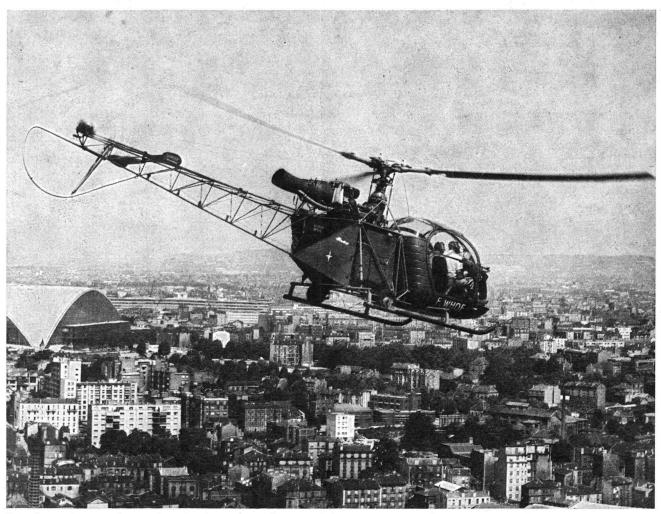
Der französische Hubschrauber Alouette II ist bereits seit einigen Jahren in der schweizerischen Flugwaffe eingeführt. Es ist der erste im Gross-Serienbau hergestellte, mechanisch angetriebene Turbinenhubschrauber. Schon im Jahre 1955 schlug dieser Drehflügler den einstigen Höhenweltrekord für Hubschrauber, wobei er mit 8209 Metern Höhenflug sämtliche Helikopter in den Schatten stellte.
