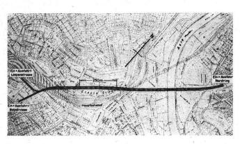
Unterirdische Westtangente in Bern. Stollen mit zwei Verkehrstunnels zur Entlastung des Verkehrs im Stadtzentrum (im Raume des neuen Hauptbahnhofes), Zugleich Trägerin der Expresstrasse. Länge 700 m. Verkehrskapazität von 2800 Personenwageneinheiten pro Stunde. Für den Kriegsfall eingebaute Schutzräume für rund 10 000 Personen.
