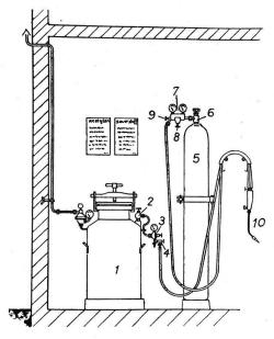
Abb. 2. Azetylen-Entwickleranlage. 1 Azetylenentwickler, 2 Austrittsbahn, 3 Druckreduzierventil, 4 Abgangshahn, 5 Sauerstofflasche, 6 Flaschenventil, 7 Druckreduzierventil, 8 Druckregulierschraube, 9 Abgangshahn, 10 Brenner.
