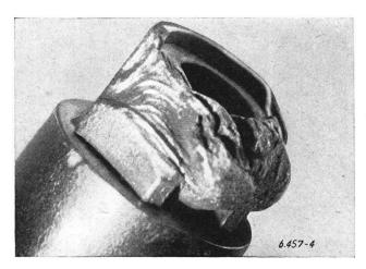
Abb. 14. Injektor mit angeschmolzener Injektordüse. Die Dichtungsfläche war beschädigt. Es kam zu einem Gasübertritt, einem Flammenrückschlag und einem kurzzeitigen Brand im Brenner.
