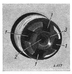
Abb. 10. Injektor mit blanker Dichtungsfläche. 1 Azetylenzuführungskanal, 2 Sauerstoffzuführungskanal, 3 Dichtungsfläche.
