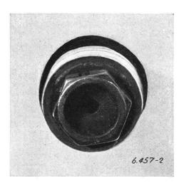
Abb. 12. Injektor mit vollständig verrusster Dichtungsfläche.
