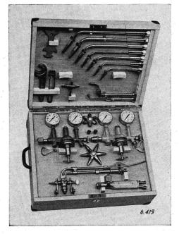
Abb. 18. Tragbarer Holzkasten für Schweiss- und Schneidgeräte.
