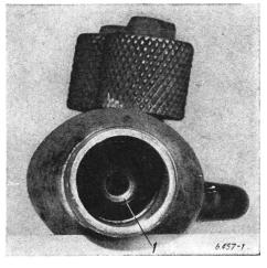
Abb. 11. Blick in den Handgriff. 1 blanke Dichtungslinie.
