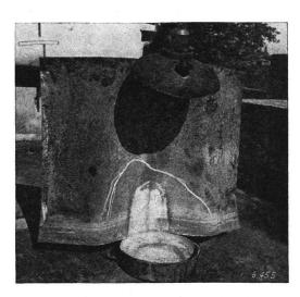
Abb. 8. Explodierter Gasbehälter eines Azetylenapparates. Der Schaden ist darauf zurückzuführen, dass ein Einsatz mit zu kurzem Schaft verwendet wurde und deshalb die Injektordüse bei der Dichtungsstelle nicht auflag. So konnte Sauerstoff nach rückwärts in den Entwickler gelangen. Es bildete sich ein explosives Gemisch, und beim Anzünden des Brenners sprang die Flamme in den Apparat. Dies war allerdings nur möglich, weil auch in der Wasservorlage die Rückströmsicherung fehlte.
