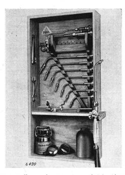
Abb. 19. Wandkasten für Schweiss- und Schneidgeräte.
