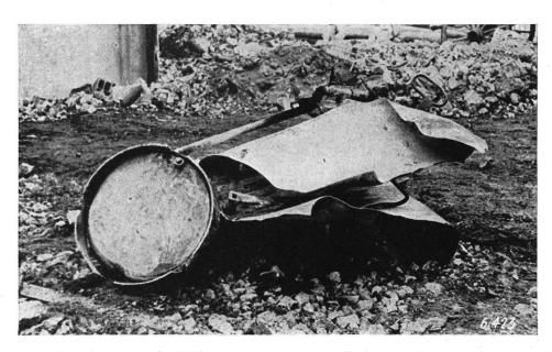
Abb. 1. Azetylenentwickler, der wegen des Rückströmens von Sauerstoff und nachfolgenden Flammenrückschlags explodierte. Die Brennermündung war durch Metallspritzer verstopft. Es handelt sich um einen ältern Apparat, bei dem die zusätzliche Rückströmsicherung fehlte.
