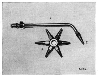
Abb. 16. Brenner und auswechselbare Spitzen. 1 Brennereinsatz, 2 Brennerspitze, 3 sechs Wechselspitzen.
