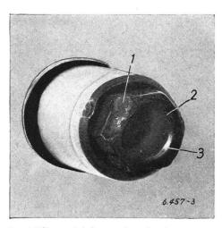
Abb. 13. Beschädigter Injektor mit teilweise verrusster Dichtungsfläche. 1 Beschädigung der Injektordüse, 2 verrusste Dichtungslinie, 3 blanke Stelle der Dichtungslinie.
