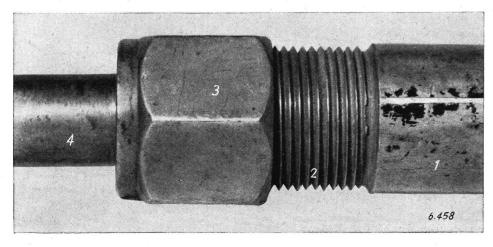
Abb. 15. Verbindung von Schweisseinsatz und Brennerhandgriff. 1 Handgriff, 2 Gewinde am Handgriff, 3 Ueberwurfmutter, 4 Brennereinsatz.
