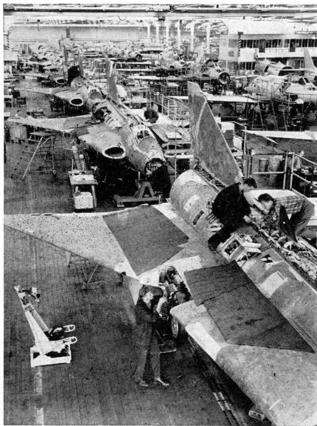
Die Serienfabrikation des Überschall-Allwetter-Jagd- und -Erdkampfflugzeuges SAAB 35-B «DRAKEN» läuft im schwedischen Flugzeugwerk zu Linköping auf vollen Touren. Auf dem Bilde sieht der «Protar»-Leser eine Baureihe dieses Flugzeugtyps. Die zweite Baureihe (rechts oben beginnend) ist der zweisitzige Allwetter- und Nachtjäger-Kampfflugzeugtyp SAAB 32-B «LANSEN».
