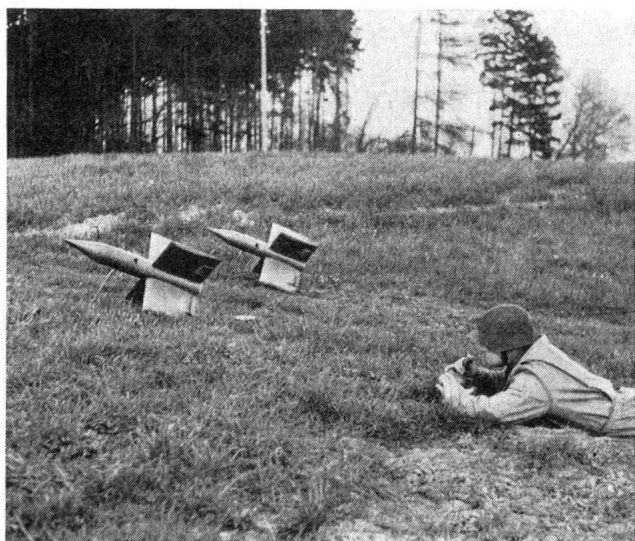
Die neue lenkbare Panzerabwehrrakete wird mittels eines Kommandodrahtes ins Ziel gesteuert.
