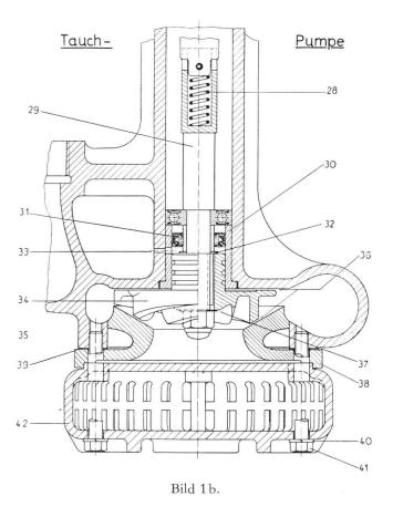
In Bild 1b sieht man nun, wie diese motorische Kraft in Saugkraft umgewandelt wird. Mittels einer Welle (29) wird der Rotor (11) mit dem Flügelrad (34) verbunden. Letzteres und sein Flügelraddeckel sind aber derart gebaut, dass das Wasser gezwungenerweise in die Entleerungsleitung abgestossen wird. Als Flügelradschutz ist ein Einlass (42) filterartig vorgebaut.
