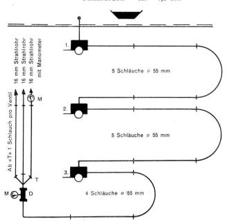
Legende: T = Teilstück; M = Manometer; D = Durchgangsstück für Manometeranschluß
