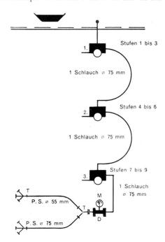
$\label{eq:Legende: T} \mbox{Legende: T = Teilstück; } \mbox{M} = \mbox{Manometer; } \mbox{P. S.} = \mbox{Probeschlauch}$
