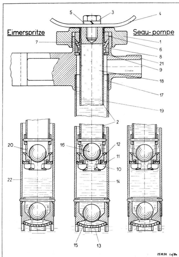
raum (14) befindende Wassersäule geschlossen und das Kolbenventil (16) geöffnet. Da der Kolben bereits mit Wasser gefüllt ist, wird das angesogene Wasser durch die vier Seitenlöcher (20) des Kolbens (2) in den Raum (17) verdrängt und durch den Anschlussstutzen (21) nach aussen getrieben.
