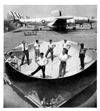
Der Känguruh —, der Radar-Bauch einer «fliegenden Radar-Station»
