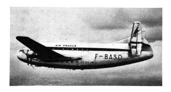
Bréguet 763 «Deux Ponts» (mit vier Motoren Pratt & Whitney von je 2430 PS ausgerüstet)
