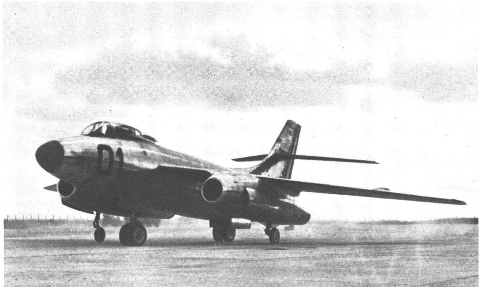
(Das Flugzeug besitzt zwecks Verkürzung seiner Landestrecke den sogenannten Brems-Fallschirm. Die Besatzung verfügt über eine Druckkabine mit Panzerung und Schleudersitz-Aggregat)
