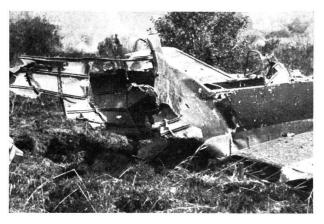
Wirkung einer 8-cm-Sprengrakete Oerlikon auf Ganzmetall-Flugzeug (Messerschmitt). Abschuss der Rakete vom Flugzeug. Nach den heutigen Anforderungen soll im Erdkampfeinsatz von Flugzeugen aus beispielsweise ein Panzerkampfwagen auf Distanzen von 500—1000 m sicher getroffen werden. Aus diesen Bedingungen heraus zeigt es sich, dass die Streuung des Raketenbeschusses kleiner sein muss als 10 Promille.
