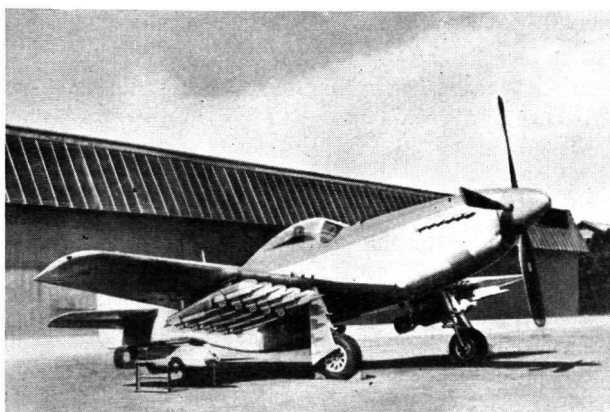
Mustang-Jagdflugzeug mit 8-cm-Pulverraketen Oerlikon bewaffnet
