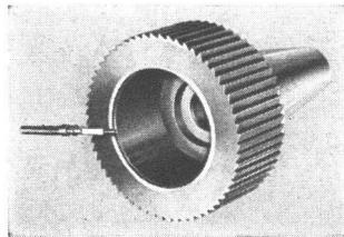
Unser neuer Carréfräser in Hartmetall bietet Ihnen gewaltige Vorteile: Grosse Schnittgeschwindigkeit 60 m/min, grosser Vorschub, bis 250 mm/min, lange Standzeit, leichtes Nachschleifen. Die bearbeitete Fläche ist absolut flach und wie poliert.
