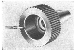
Unser neuer Carréfräser in Hartmetall bietet Ihnen gewaltige Vorteile: Grosse Schnittgeschwindigkeit 60 m/min, grosser Vorschub, bis 250 mm/min, lange Standzeit, leichtes Nachschleifen. Die bearbeitete Fläche ist absolut flach und wie poliert.
